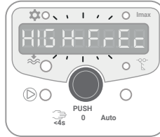
Frecuencia excesiva de arranques
