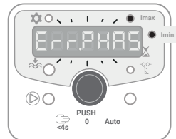
Falta de fase
