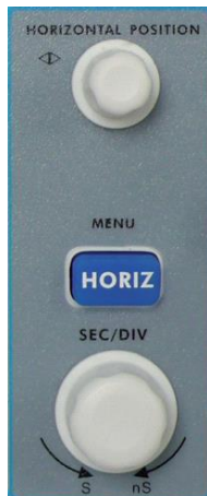
Figura 13. Zona de Control Horizontal.
